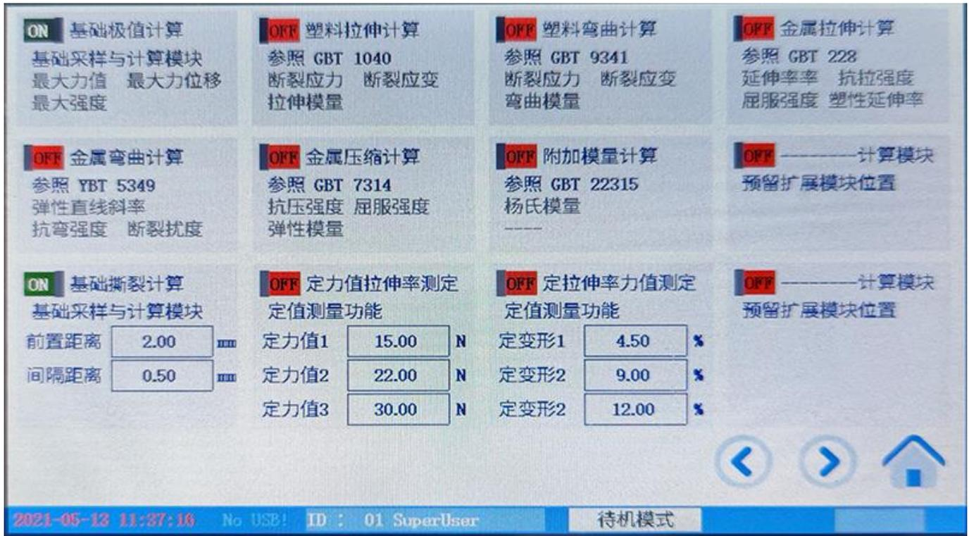
试验系统采用的使控制与计算分离处理，以行程控制先完成试验过程，然后按计算设定再对试验过程的数据进行后置计算。
