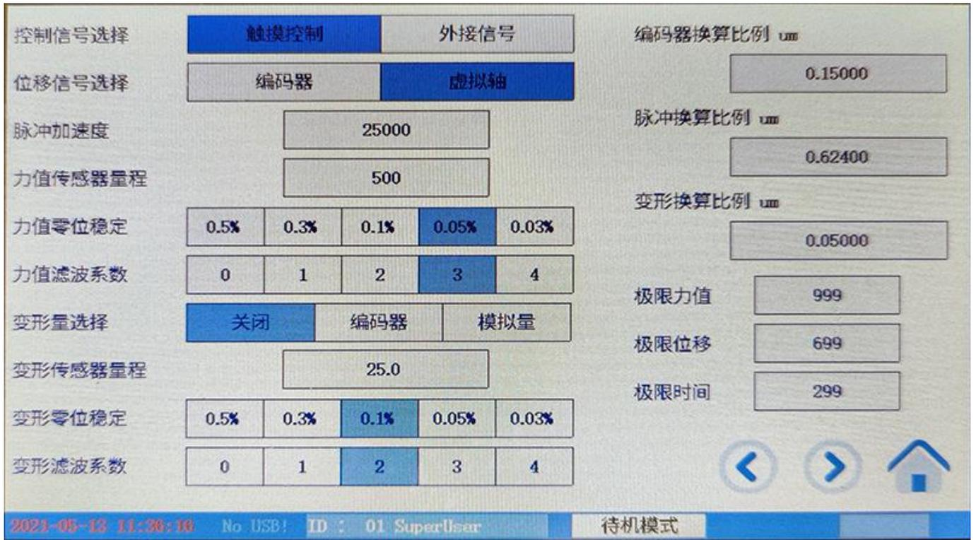
控制信号： 触摸控制常态有效，不选择外接信号时，外部输入信号无效
