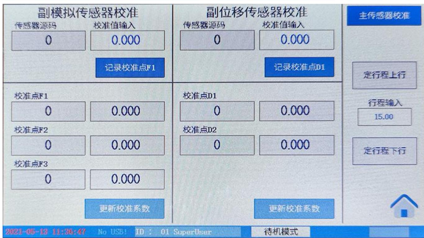
用于校准变形量传感器，一个编码器接口的副位移传感器、一个模拟量接口的副模拟量传感器。具体操作过程同主传感器校准。
