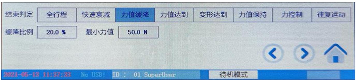
力值大于最小力值，并跌落到达最大力值的设定比例数值，判定试验完成。没有时间限制，没有边缘特性要求。判定后形成断裂标志记录。
